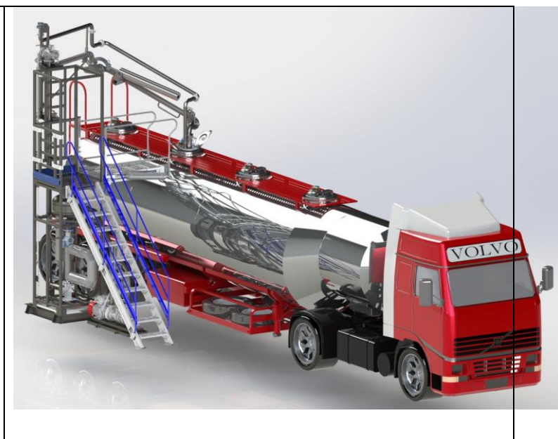
Стойк верхнего налива автоцистерн с жестким трубопроводом отвода паров
