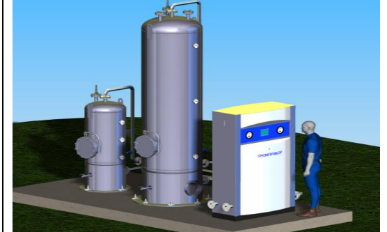
Установки сжижения ЛУВ для АЗС ( «Промприбор») – адсорбция на угле
