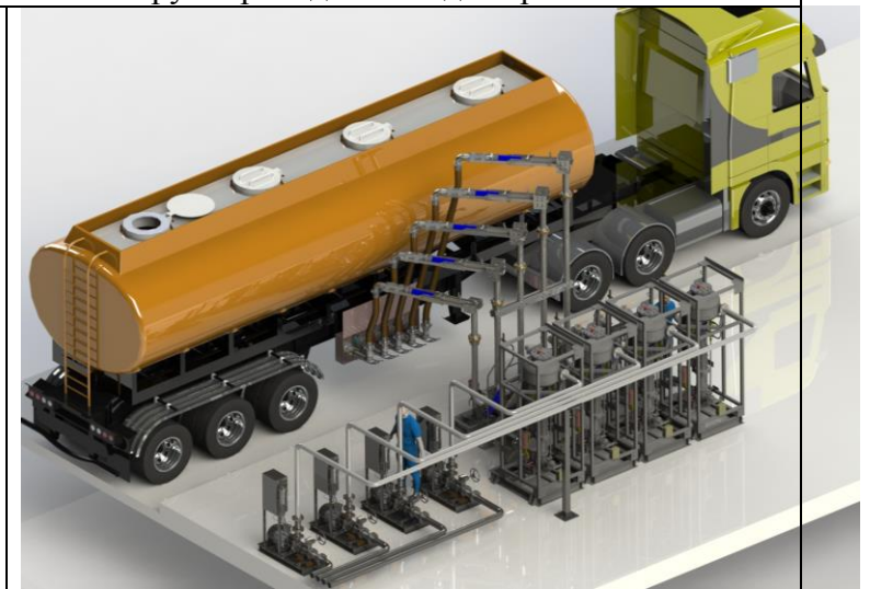
Стойк нижнего налива автоцистерн с трубопроводом отвода паров
