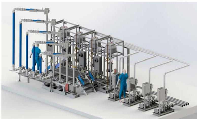
Система измерительная нижнего дозированного налива светлых нефтепродуктов в автоцистерны с обеспечением коммерческого учета в объемных (и массовых единицах при установке массового расходомера) АСН-8НГ Модуль Ду100 4/4 в комплектации объемными счетчиками или массовыми расходомерами, с насосами, обслуживающая до четырех отсеков а/ц с одной стороны наливного островка.
