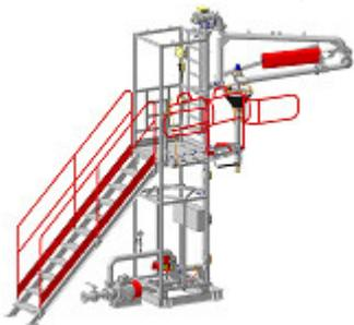
Автоматизированный стояк верхнего налива с клапаном отсекателем для светлых нефтепродуктов, без функции учета, АСН - 4ВГ модуль Ду100 (ДПУ-1-0-0) с возможностью прекращения налива при срабатывании датчика предельного уровня, в комплекте с опорной металлоконструкцией, обслуживающий один отсек автоцистерны с одной стороны наливного островка.
