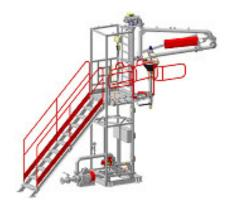
Автоматизированный стояк верхнего налива с клапаном отсекателем для светлых и вязких нефтепродуктов, без функции учета, обслуживающий один отсек автоцистерны с одной стороны наливного островка
