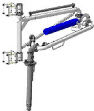
Стойк верхнего налива нефтепродуктов в автоцистерны без функции учета, без автоматизации АСН — 4В Ду100 (0 — 0 (1)) У2 с возможностью ручного прекращения налива, в комплекте с ручным клапаном-отсекателем, в комплекте с опорными стойками для крепления к металлоконструкции (1 — наличие ручного клапана отсекавателя).
